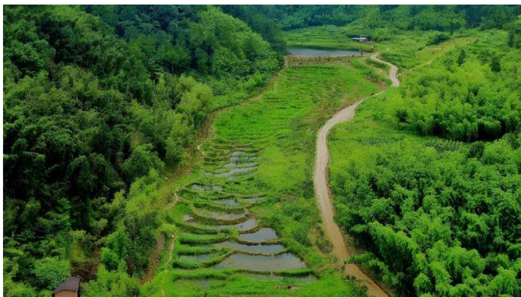
Pequeños humedales en terrazas para la retención de inundaciones y el tratamiento de la contaminación en Liang Ping, Chongqing, sudoeste de China. © Lyu Cai.
